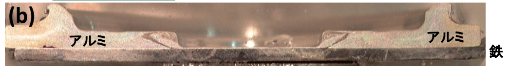
FSSWで得られたアルミ/鉄の異材接合継手の外観(a)と断面写真(b)
