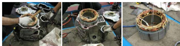
モーター取外し作業(コイル部)
